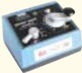
家庭用の交流100Vを直流0~12Vに変換して使用するためのパワーパック。レールに電気を流すことによって、動力を搭載している車輛を動かすしくみ。
